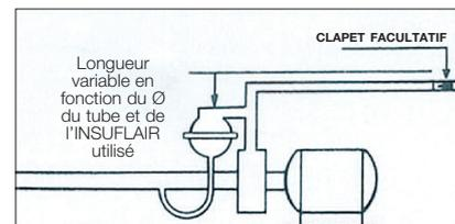
Ne pas oublier qu'un clapet "éventuel" sur le refoulement ne remplace pas le clapet d'aspiration (clapet crépine ou autre) qui lui, est obligatoire dans tous les cas où le niveau de l'eau pompée est plus bas que le groupe.
