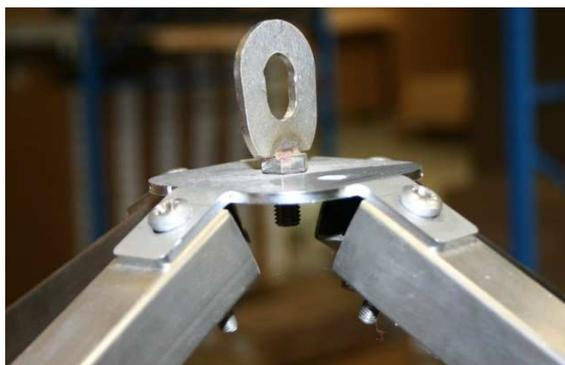
8 vis 6x16 + 12 vis 6x35 + 20 rondelles M6 + 20 écrous M6
