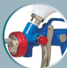
Grâce au bouton de réglage du jet, vous pouvez obtenir un réglage précis de la pression à la sortie du pistolet. C'est cette pression qui va déterminer le bon éclatement de la peinture et la taille du jet.
