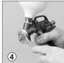
Desserrer la buse à l'aide d'une clé plate de 19.
